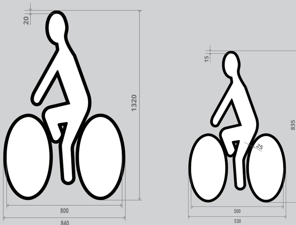
La partie blanche du symbole est réalisée en BPt PREMARK™ RS2+ (rétro réfléchissant).
